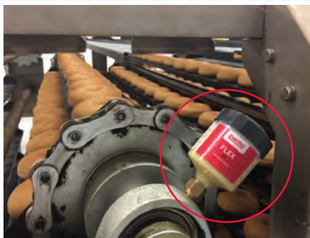
Stehlagerschmierung an einer Kühlstrecke für Backwaren
