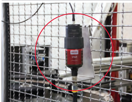
Automatische Schmierung einer Gleitführung
